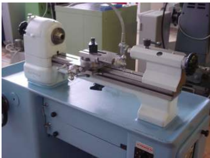
Tour outilleur / Werkzeugma- cher Drehbank Schaublin 102
