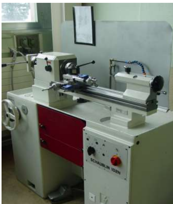
Tour outilleur / Werkzeugma- cher Drehbank Schaublin 102 N
